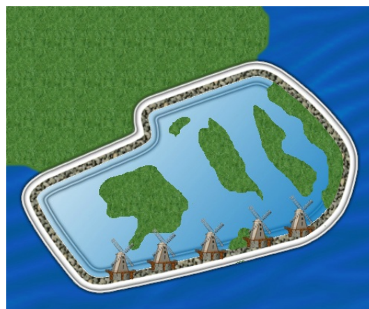
Ker padavinska voda s polderjev ne odteka, jo s kanalov dvigujejo s črpalkami na veter. Le okoli desetina naprav je resnično mlinov, ostalo so le strukture, ki prekrivajo črpalke.
