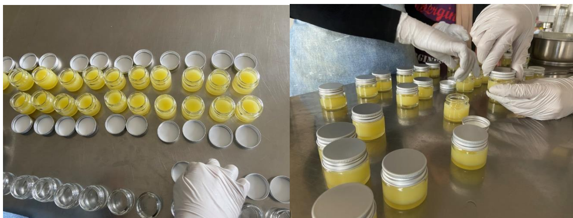
Slika 21: Prelitje v čašo z lijem za lažje polnjenje embalaže, zapiranje embalaže in končni izdelek. Vir: avtorice
