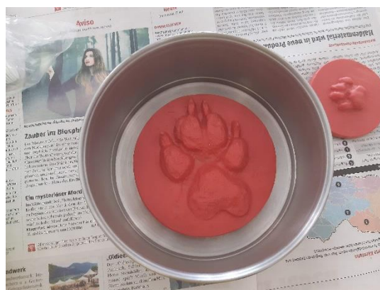
Slika 8. Pozitiv v posodi, ki ga bomo prekrili s silikonom. Vir: avtorici
