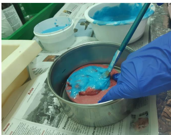
Slika 9. Prekrivanje s silikonom. Vir: avtorici
