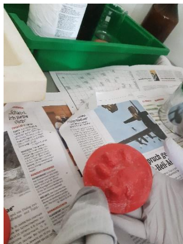
Slika 6. Premaz modela z ločevalcem. Vir: avtorici
