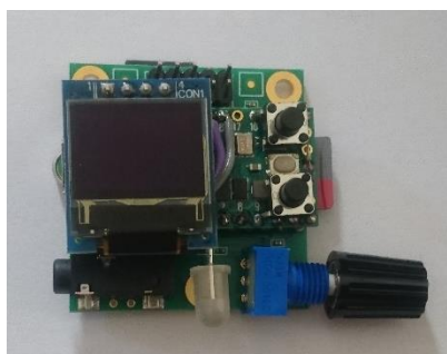
Slika 1: Procesorska ploščica s prikazovalnikom ter avdio vmesnikom (levo) in shematski prikaz komponent (desno).
