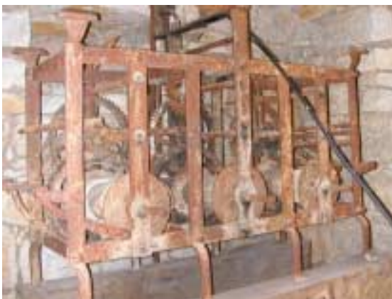
Zobniški prenosi pri mehanizmu ure na cerkvenem zvoniku
