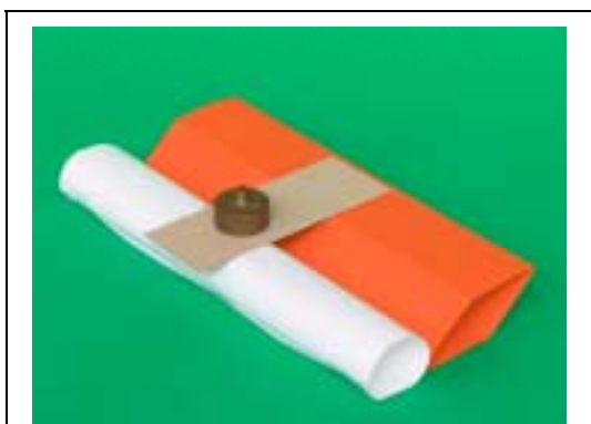
Če valjasti in kvadratni profil na krajišču nista vpeta, ne preneseta prečne obremenitve.
