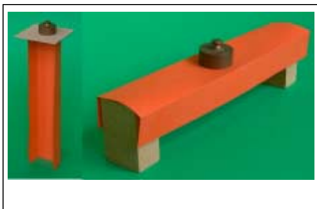
Preskus trdnosti U profila na upogib in tlak
