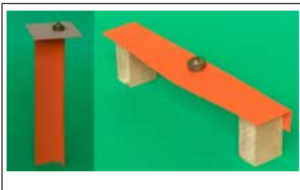
Preskus kotnega profila na upogib in tlak
