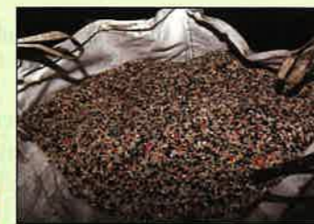
Opran in zmlat plastični material ohišij akumulatorjev, pripravljen za nadaljnjo predelavo
