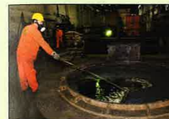
Odstranjevanje nečistoč iz surovega svinca (rafiniranje)
