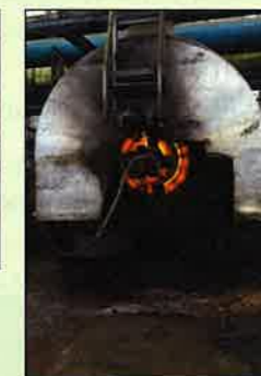
Taljenje odpadnega svinca v bobnasti peči
