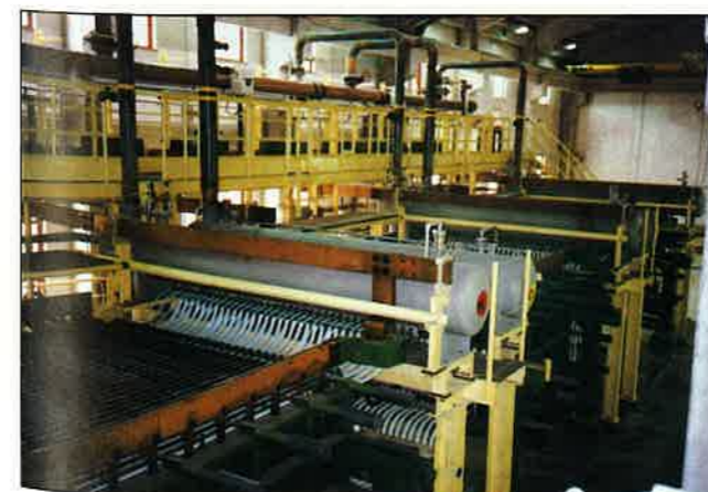
Slika 5 V tovarni kemijskih izdelkov TKI Hrastnik pridobivajo iz slanice klor, vodik in natrijev hidroksid. Iz klora in vodika nato proizvajajo klorovodikovo kislino.
