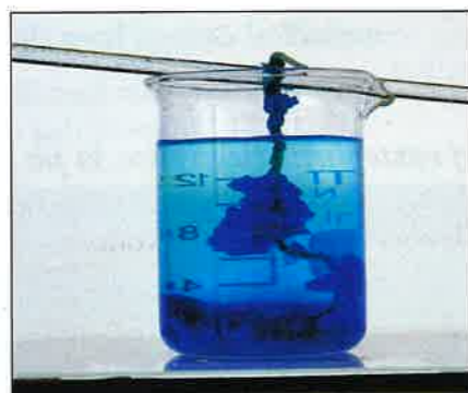
Slika 3 Iz nasičene raztopine bakrovega sulfata izpadejo modri kristali.
