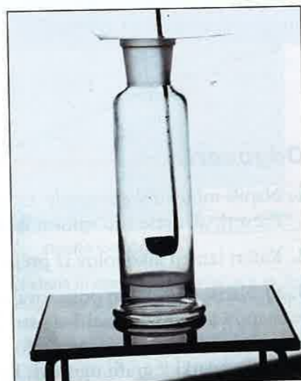
Slika 1 Pri gorenju etanola nastaneta voda in ogljikov dioksid.
