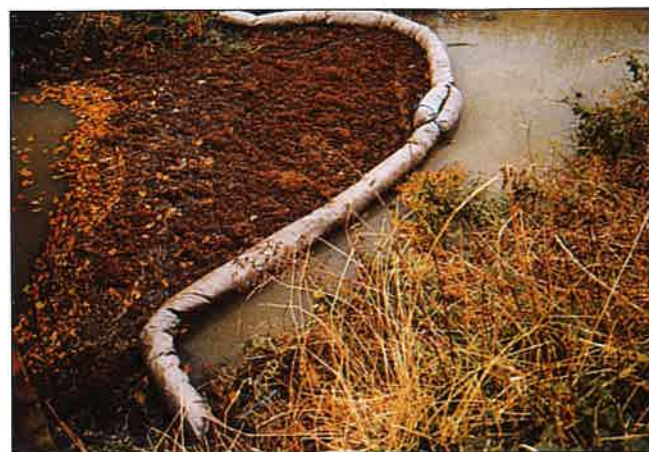
Slika 4 Superabsorbirni polimeri lahko vpijajo večje količine vode in jih uporabljamo pri odstranjevanju nečistoč v vodi.
