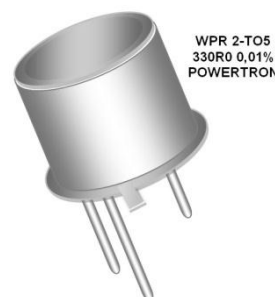
Slika 66: Specialni žični upor 330,0 Ω ± 0,01 % v hermetičnem ohišju
