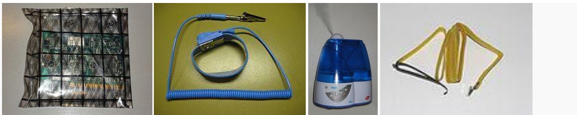
Slika 96: Načini zmanjševanja nevarnosti statične elektrike pri rokovanju z elektrostatično občutljivimi komponentami (antistatična vrečka, antistatična zapestnica, vlažilec zraka, antistatični trak)
