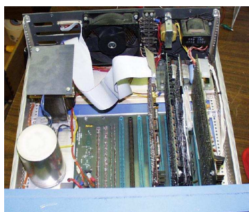
Slika 8: Prvi mikroročunalnik ALTAIR 8080
