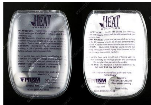
Slika 2: Fotografija kaže blazinici z natrijevim acetatom. Levo je blazinica s podhlajeno tekočino, desno pa blazinica potem, ko je tekočina kristalizirala. V blazinicah je vidna kovinska ploščica.
