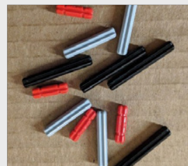
Korak 7: uporabite LEGO osi pod platformo mostu, da bo lažje nosil težo robota. Preizkusite različne dolžine osi in izberite tisto, ki most najboljše podpre in uravnoteži.
