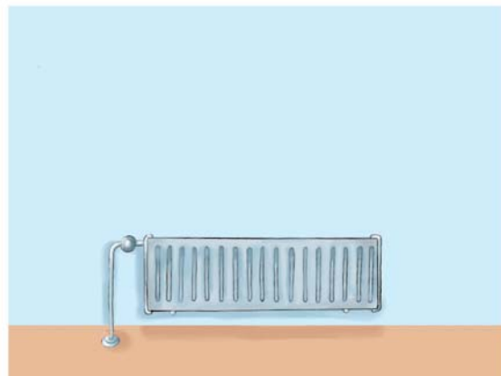
Nepravilna postavitev radiatorja
