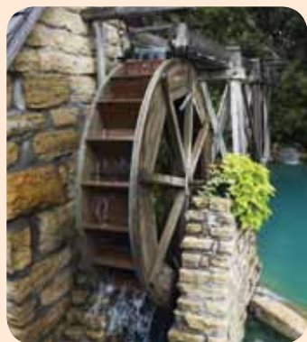
č) Vodni mlin – gibanje vode poganja kolo.
