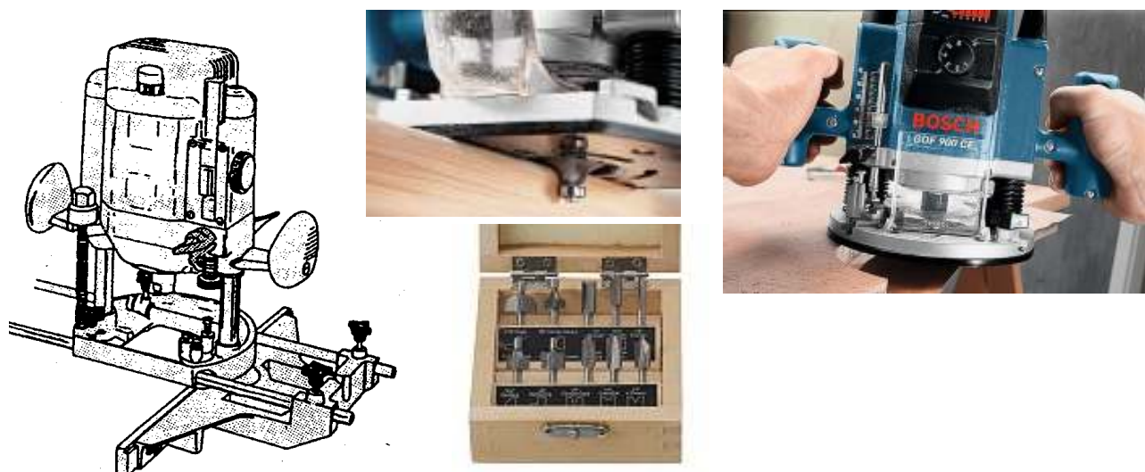
Slika 56. Ročni rezkalni stroj in komplet stebelnih rezkarjev
