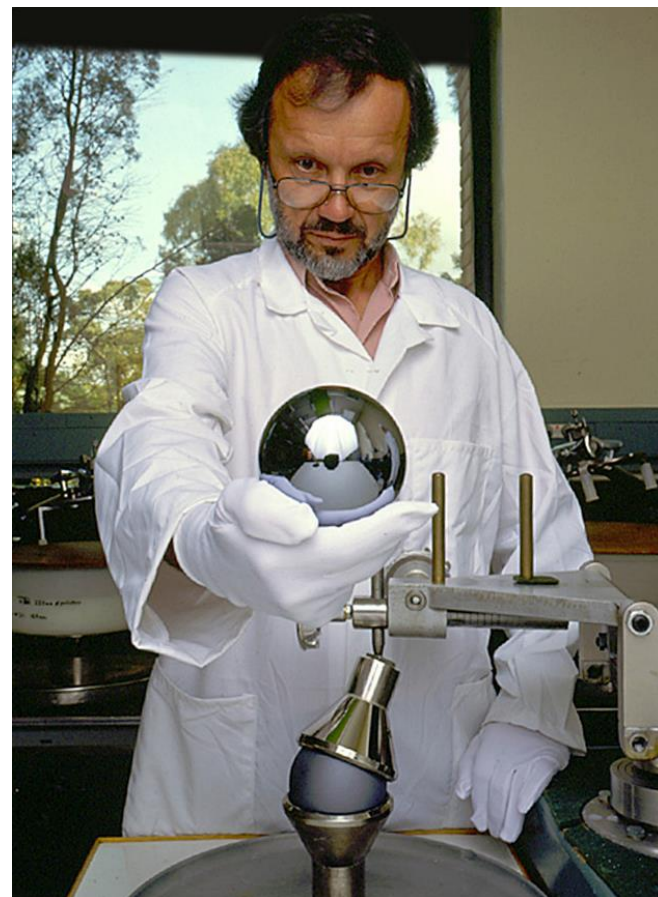
Silicijeva sfera za določitev N_A
