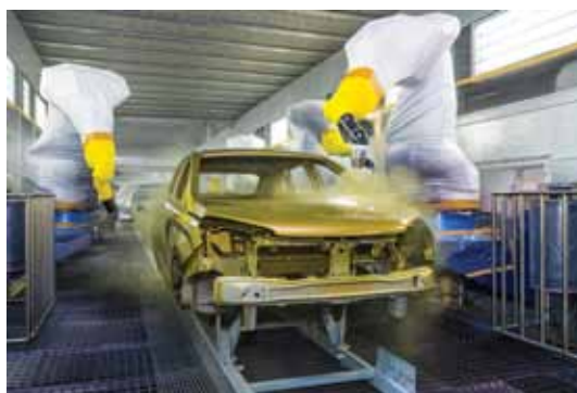
Slika 187: Barvanje karoserije avtomobila z industrijskim robotom
