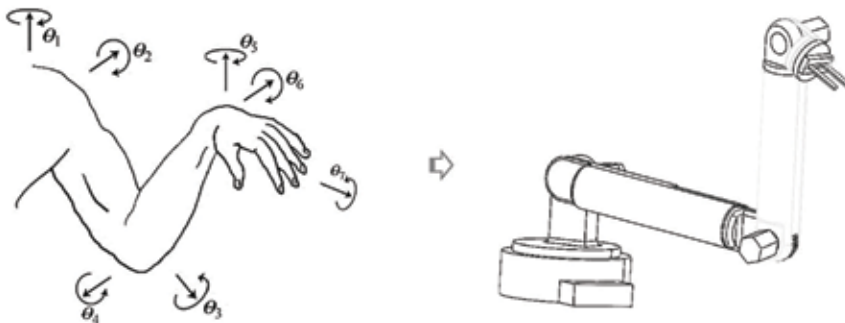
Slika 66: Človeška roka in robotski mehanizem
