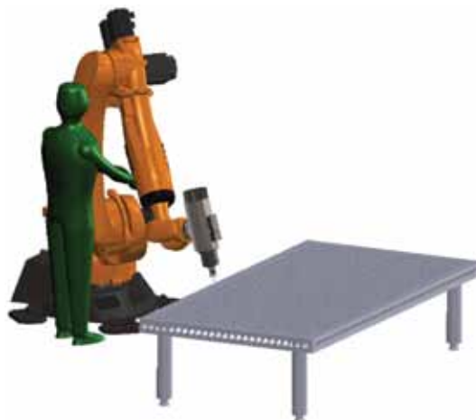
Slika 166: Možnost trka in stisnjenja pri delu z industrijskim robotom
