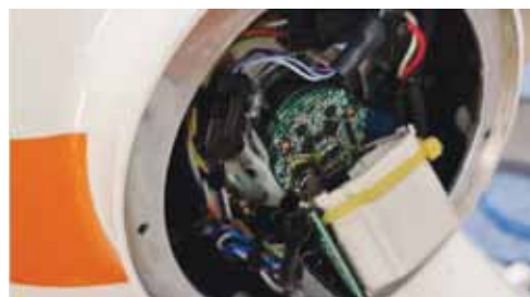
Slika 109: Resolver v osi A3 industrijskega robota
