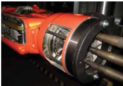
Slika 124: Prenos pogonskih motorjev na A4, A5, A6
