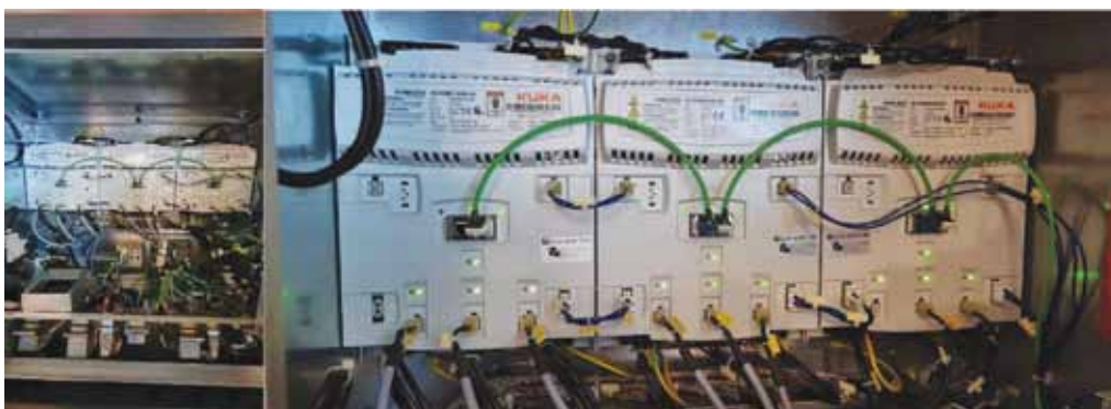
Slika 96: Servopogon industrijskega robota
