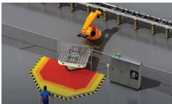
Slika 171: Zaznavanje nedovoljenih objektov v robotski celici
