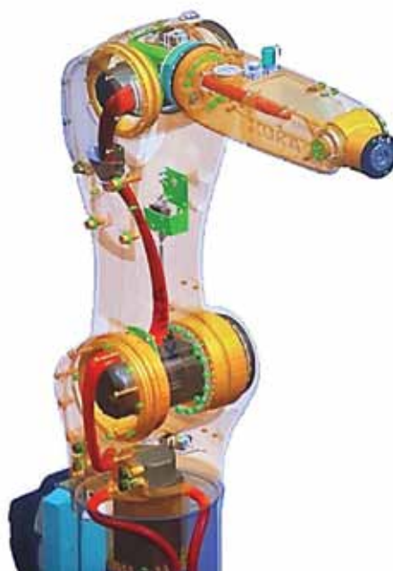
Slika 68: Notranja konstrukcija industrijskega robota
