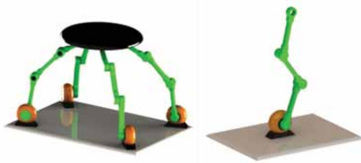
Slika 86: Koncept zaprte in odprte kinematične verige togega telesa
