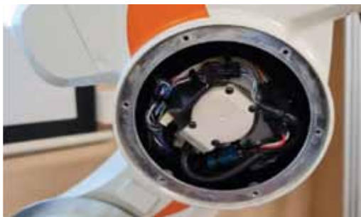
Slika 114: Resolver v osi robotskega mehanizma
