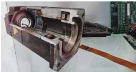
Slika 99: Prerez AC-servomotorja industrijskega robota
