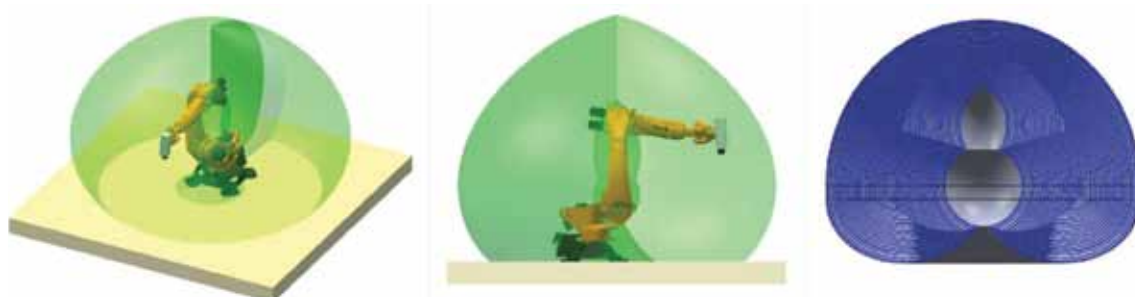
Slika 70: CAD 3D-izris delovnega prostora industrijskega robota (izometrični, stranski pogled, pogled v prerezu)
